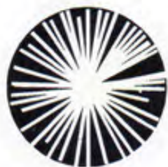
Fig. 5 - Effetto sullo schermo radar nemico di un ECM disturbatore, che genera un rumore che maschera il bersaglio creando confusione
